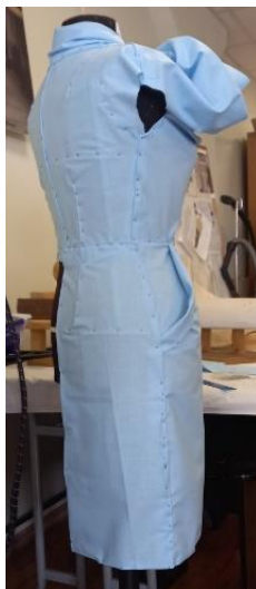
Рисунок 10 – Наколка переднего полотнища юбки и бочка
