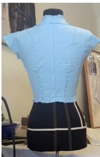
Рисунок 4 – Накладка деталей спинки
