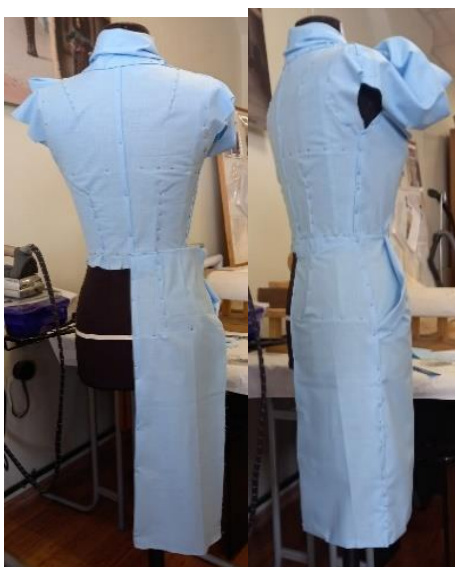
Рисунок 11 – Наколка детали спинки
