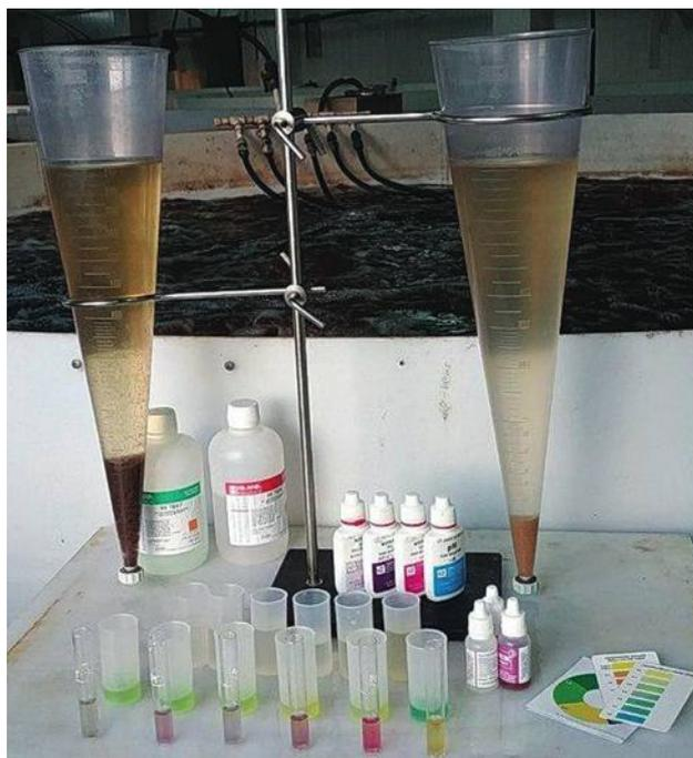
Рис. 2. Измерение количества бактериального осадка при помощи конусов Имхоффа
