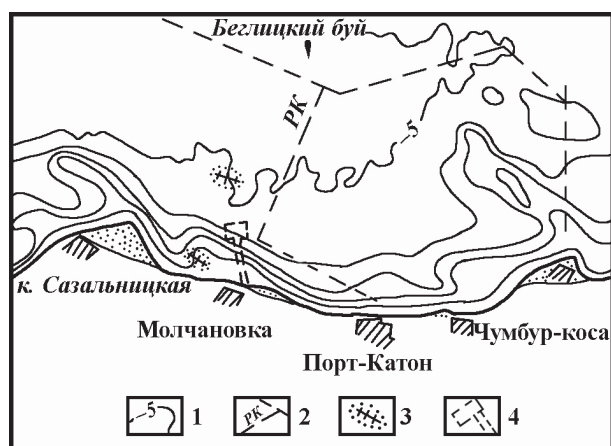
Схема строения подводного склона Таганрогского залива между Сазальнической и Чумбурской косами:
