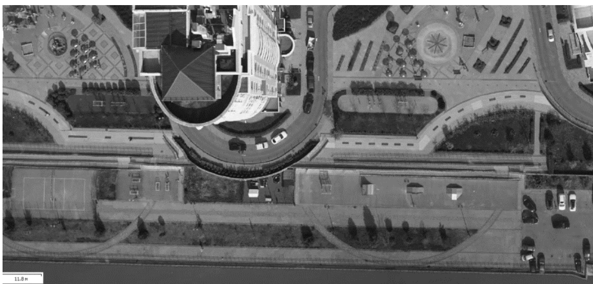
Рис. 2. Пример данных лазерного сканера – аэрофотоснимок, полученный с камеры сканера АГМ МС-3
