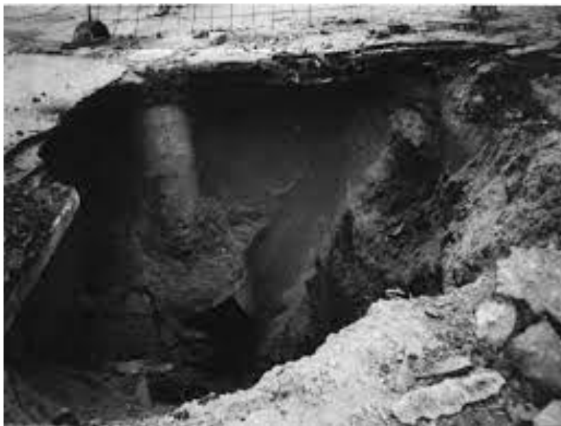
Рис. 1. Развитие суффозионного процесса на контакте грунт-трубопровод [Антошкина Е.В., 2009]
