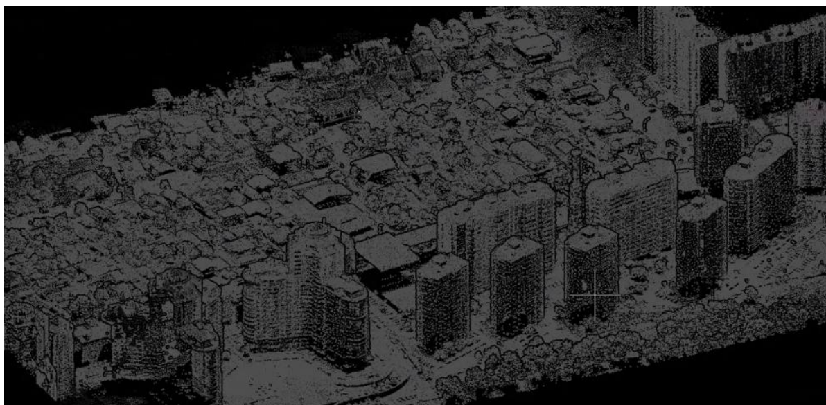
Рис. 1. Пример данных лазерного сканера – облако точек лазерного отражения полученных на ул. Кожевенной, район Тургеневского моста (составлено авторами)
