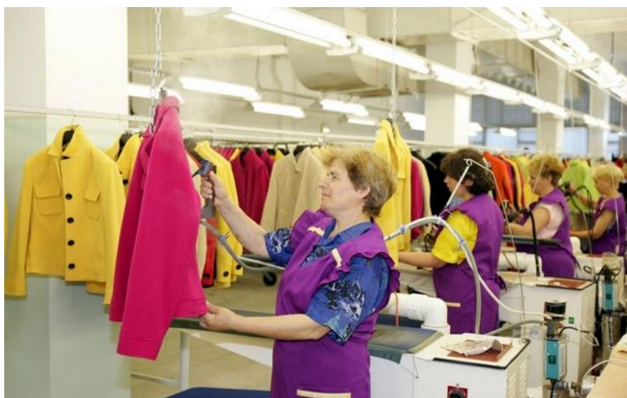
Рис. 32. Окончательная влажно-тепловая обработка изделий и контроль качества [34].
