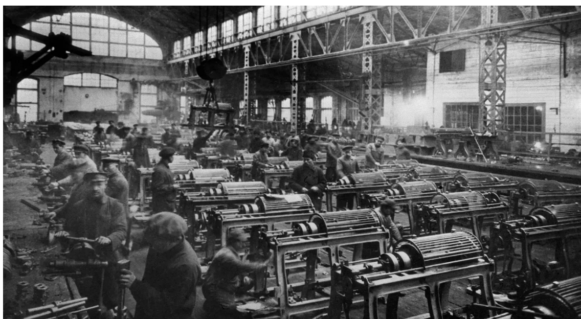
Рис. 22. Сборка первых советских текстильных машин – пеньково-прядельных полуавтоматов на заводе им. Карла Маркса в Ленинграде (1924 г.) [13]
