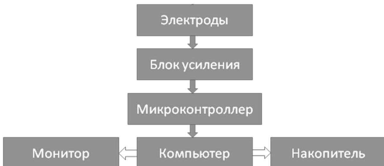
Рисунок 1- Блок-схема лабораторного стенда.
