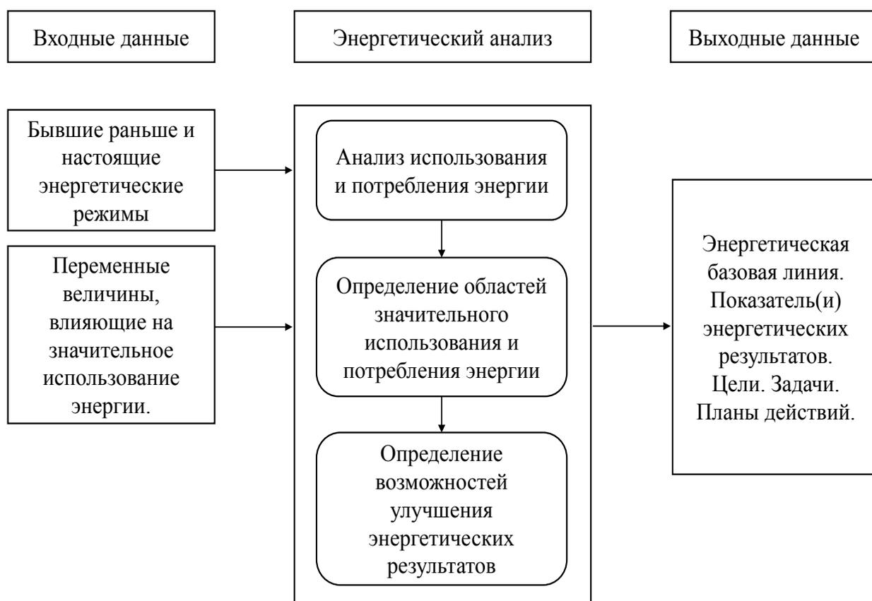
Рисунок 2 – Процесс энергетического планирования
