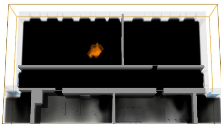
Рисунок 5 – Распространение дыма и огня через 360 с после начала пожара
