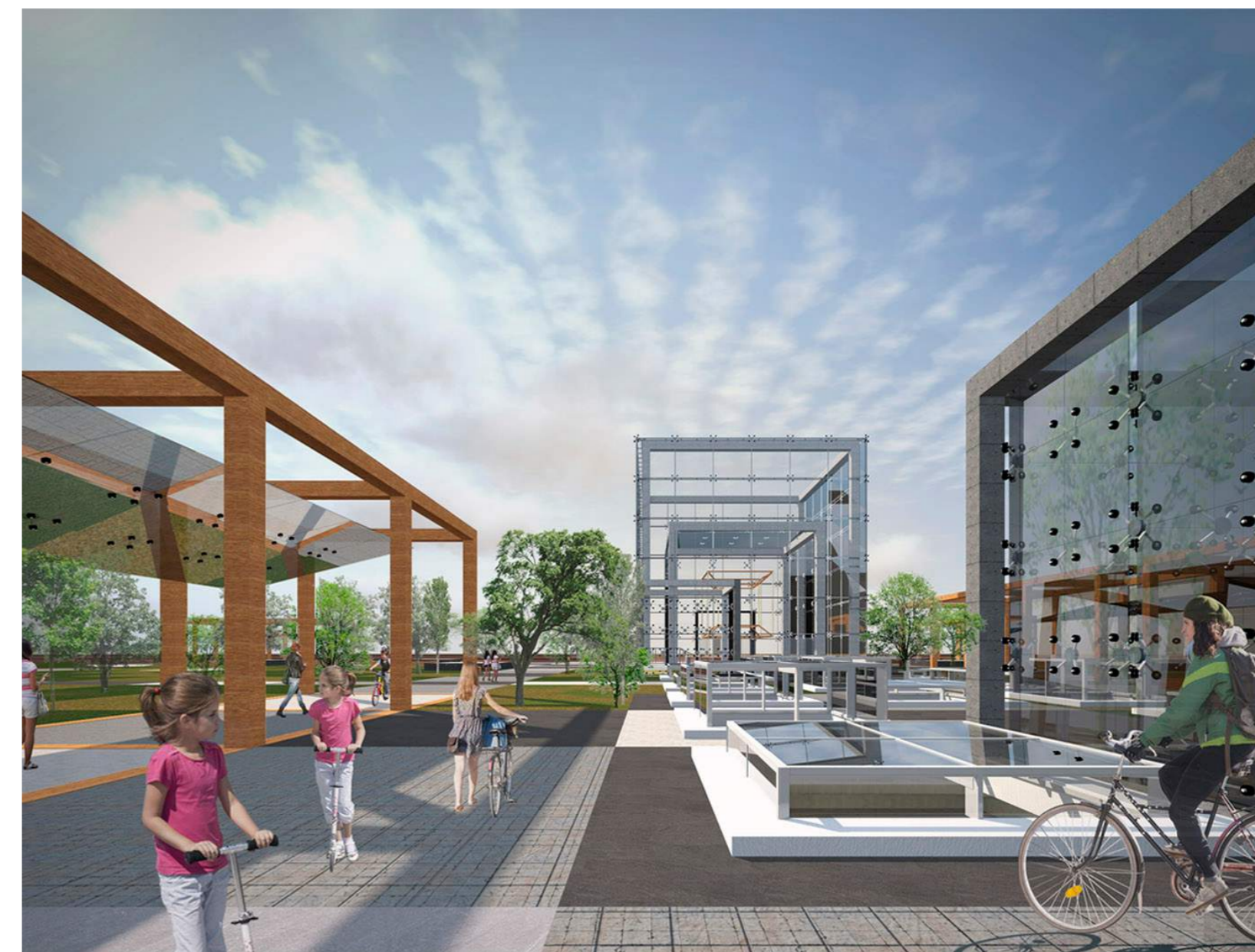
Кубический каркас создает рамки и для пожарных выходов из музея. Чтобы они воспринимались как технические сооружения, было принято решение сделать их из бетона, в отличии от деревянного благоустройства.
