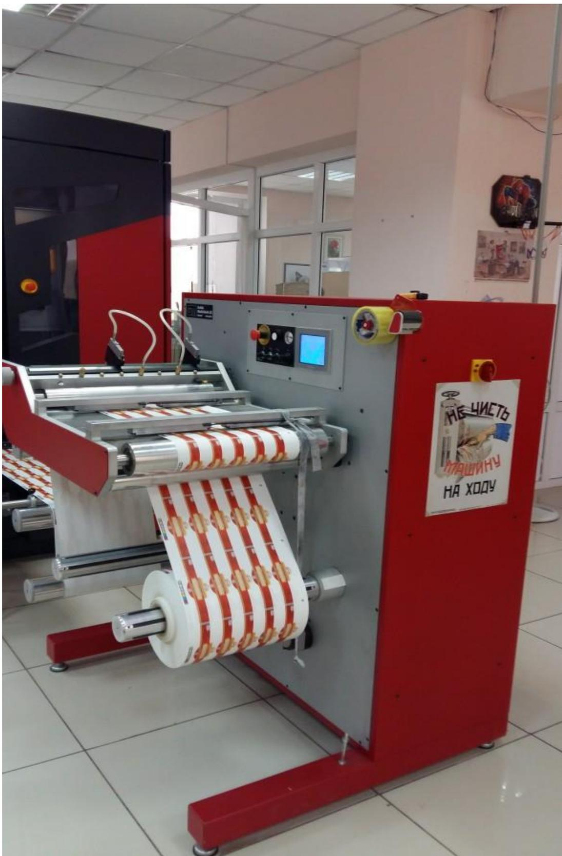
Рисунок 1 – внешний вид рулонной печатной машины
