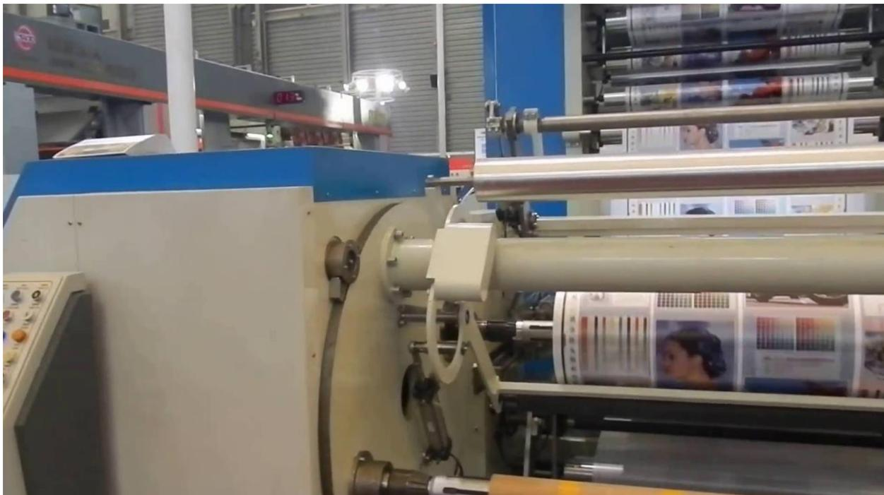
Рисунок 1 – внешний вид флексографической печатной машины
