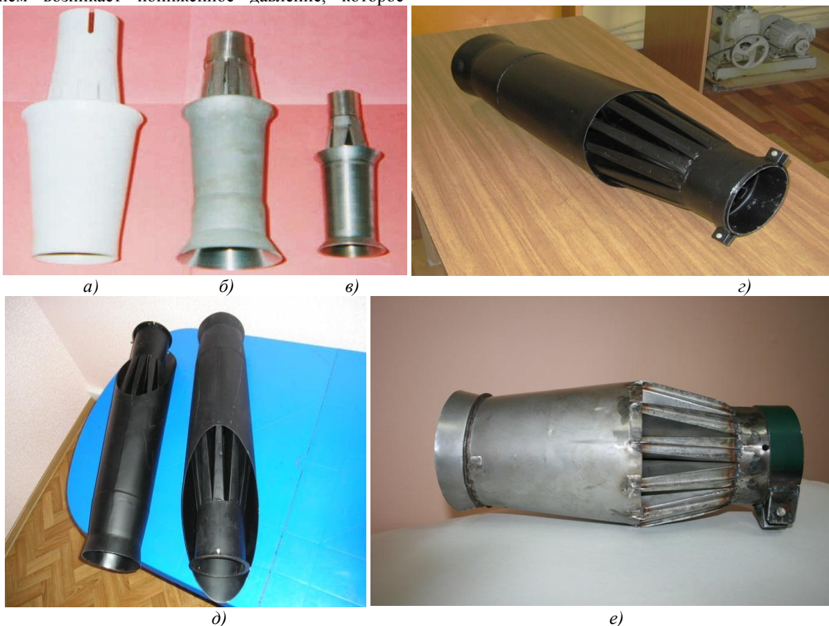
Рис.7. Эжекторные насадки для: а – VAZ 2106, б – Ока, в – мотодикл, г – городской автобус «Икарус», д – речной буксир, е – трактор «Беларусь 2022»
