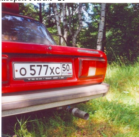
Рис. 12. Автомобиль ВАЗ-2106 с вихревым эжекторным насадком
