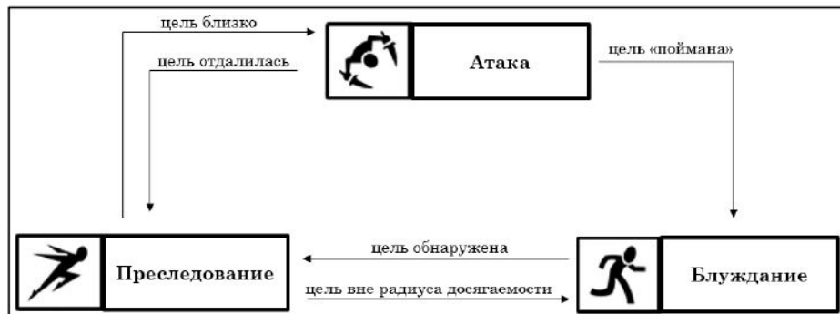
Рисунок 13 – Конечный автомат состояний «хищника»
