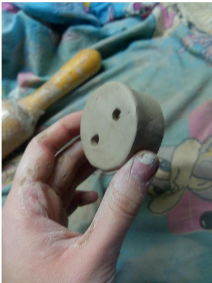
Рисунок А. 15 – Глиняная деталь для крепления патрона и лампочки
