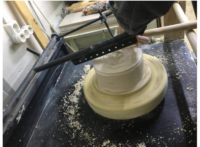
Рисунок А.9 – приспособление для устойчивой опоры
