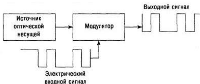
Рисунок 3 – Схема передатчика с внешней модуляцией
