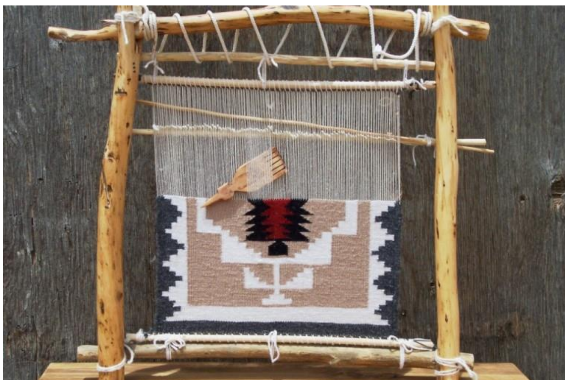
Рис. Д.3. Процесс плетения ковра на вертикальном станке
