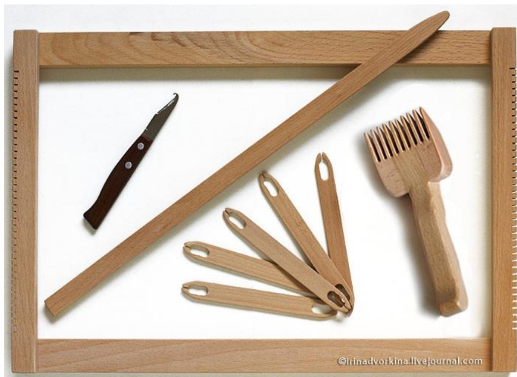
Рис. Д.1. Инструменты для ковроткачества: рама, гребень, колотушка, нож-крючок, палочка
