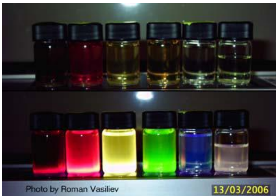
Рисунок 2 – Люминесценция образцов квантовых точек CdSe размером в диапазоне 2.0-5.5 нм, приготовленных в виде зольей. Вверху – без подсветки, внизу – подсветка ультрафиолетовым излучением
