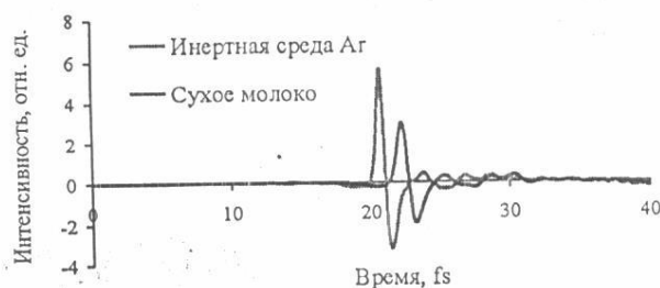
рис.2. Изменение формы импульса лазерного сигнала после прохождения образца
