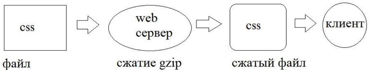
Рисунок 1.3.2.1.2 – Схема работы gzip сжатия css файла
