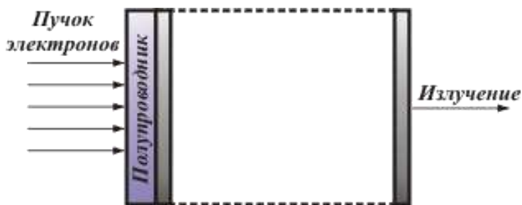
Рисунок 20 – Продольная накачка электронным пучком
