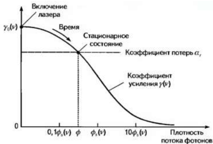
Рисунок 8 – Определение стационарного значения плотности потока фотонов.
