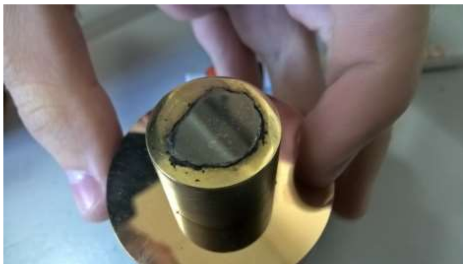
Рисунок 19 – Плоскость ниобат-литиевого кристалла после полировки
