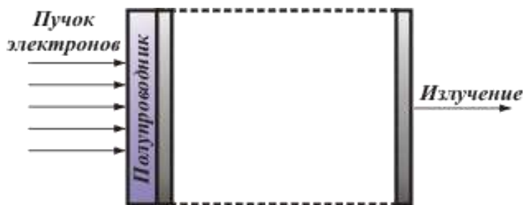
Рисунок 10 – Продольная накачка электронным пучком
