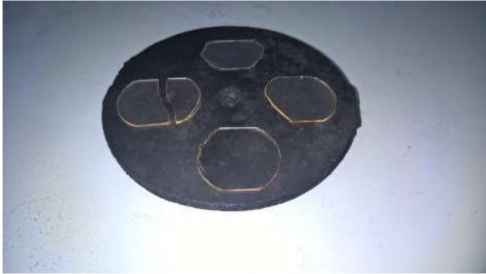
Рисунок 20 – Ниобат-литиевые кристаллы после обработки плоскостей и границей
