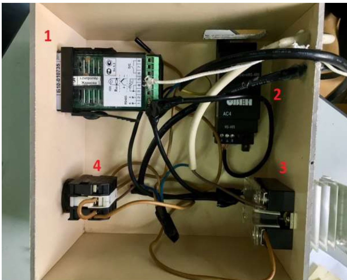
Рисунок 42 – Блок приборов для установки и поддержания температуры, а также для коммутации с управляющим компьютером
