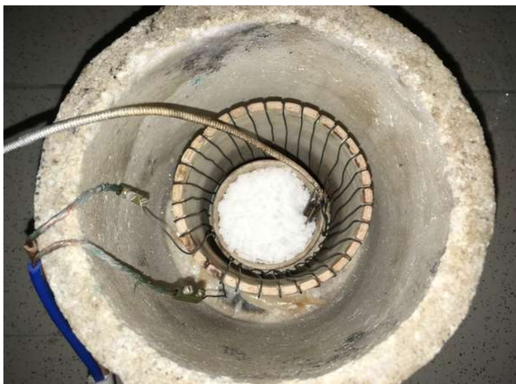
Рисунок 51 — Специальная печка, с находящимся внутри нее тигелем, в котором содержится кристалл в смеси бензойной кислоты и нитратов
