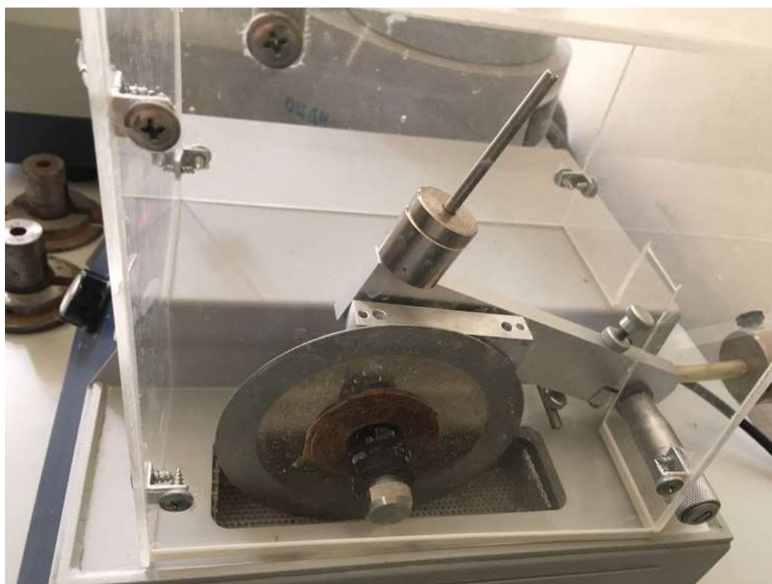
Рисунок 36 – Специальная установка для нарезки кристаллов
