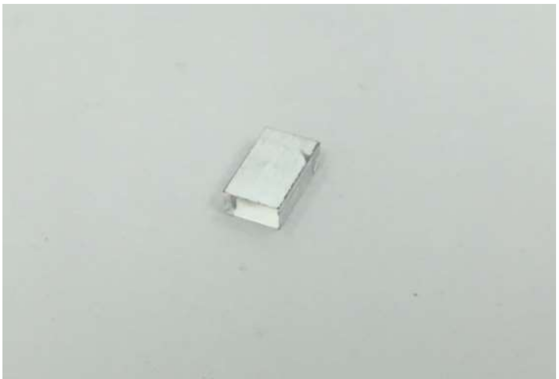
Рисунок 39 – Кристалл ниобата лития после полировки (фотография без вспышки)
