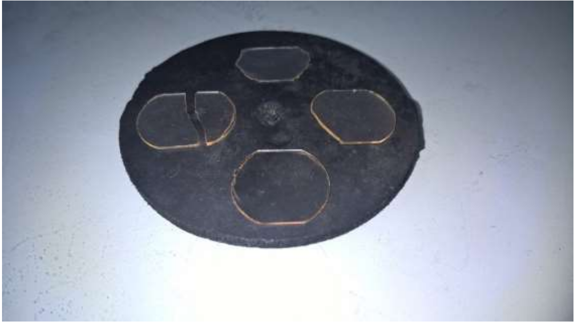
Рисунок 38 – Кристаллы ниобата лития после обработки плоскостей и граней
