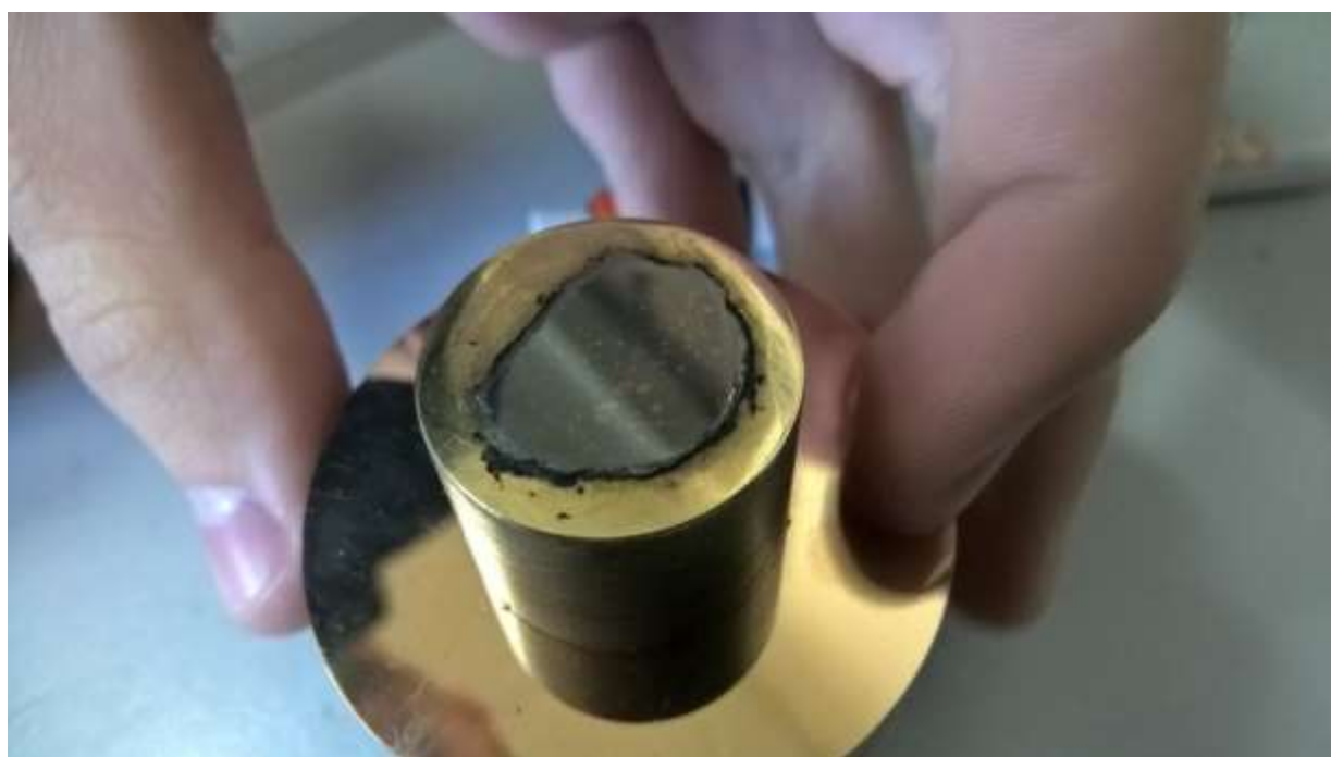
Рисунок 37 – Плоскость кристалла ниобата лития после полировки
