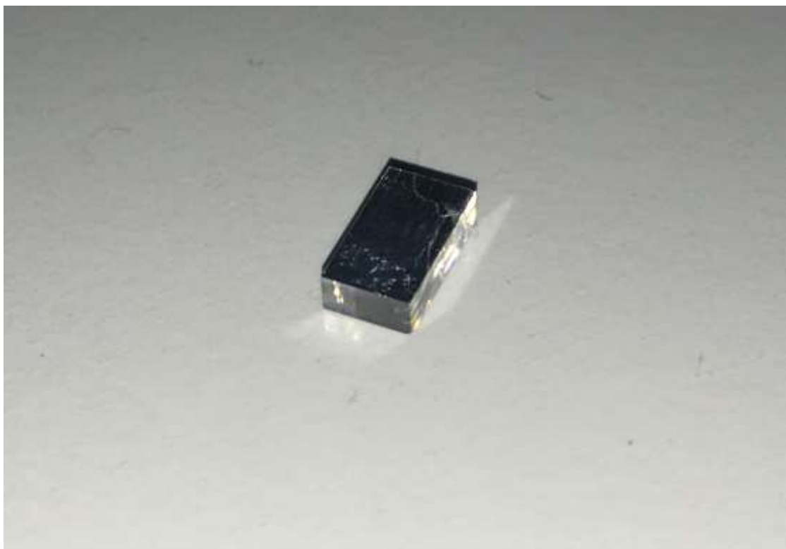
Рисунок 40 – Кристалл ниобата лития после полировки (фотография со вспышкой)
