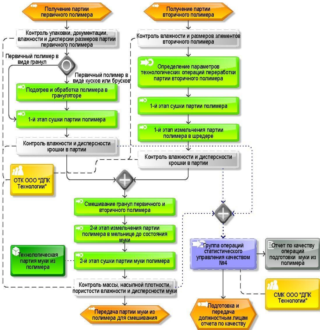
Рис. 3. EPC-модель декомпозиции функции «Подготовка полимера» технологического процесса производства профильных изделий из ДПК и операций системы статистического управления качеством
