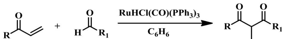
Рисунок 38 – Гидроацилирование \alpha,\beta -ненасыщенных кетонов
