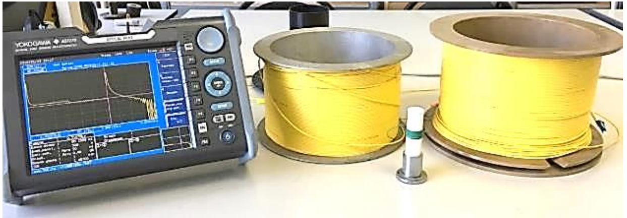
Рисунок 18 – Экспериментальный стенд для тестирования оптическим рефлектометром линии с волокнами типа G.657A и G.652
