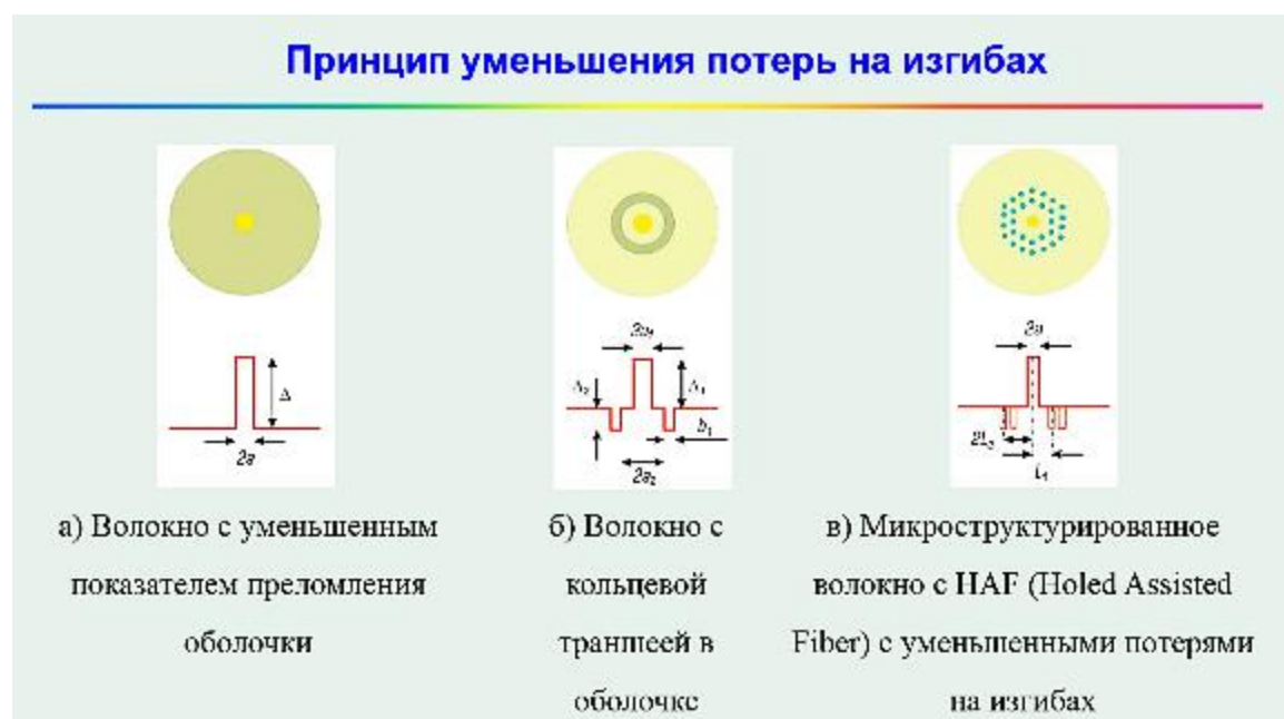
Рисунок 22 – Принцип уменьшения потерь на изгибах
