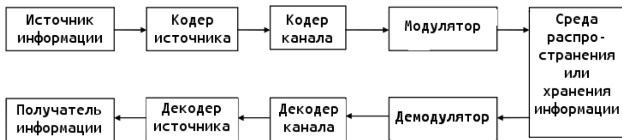
Рис. 3-6. Пути обработки информации в системах физико-технических средств связи и ИКТ
