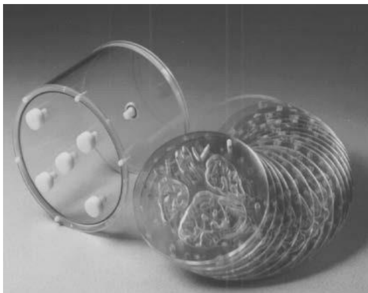
Рис. 15.14. Трехмерный фантом Хоффмана с заполняемым водой цилиндром и слоями вставок (фантом производства Data Spectrum Corporation, США)
