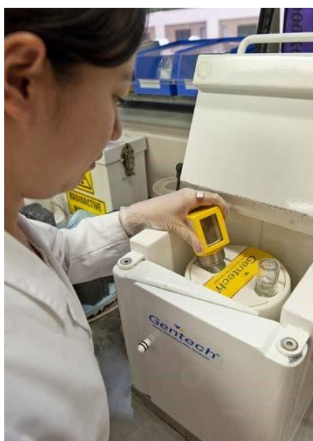
Рис. 9.9. Свинцовый гараж, окружающий генератор ^{99}\text{Mo}/^{99\text{m}}\text{Tc}
