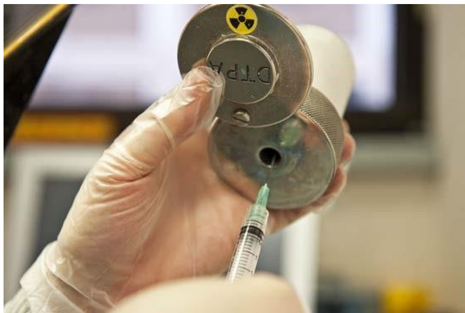
Рис. 9.10. Экранированный флакон, используемый для хранения восстановленных радиофармпрепаратов
