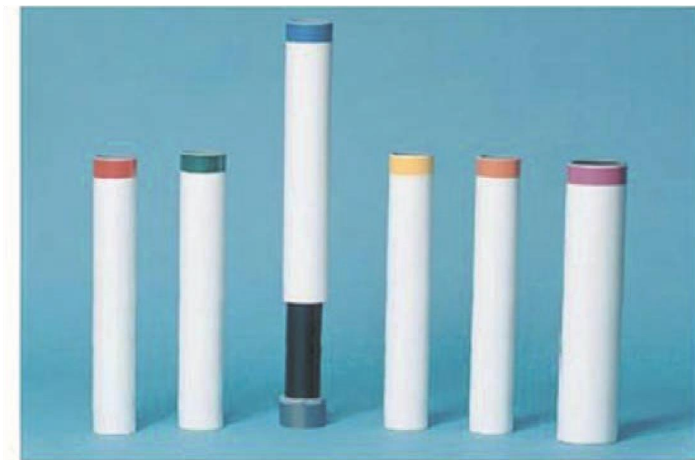
Рис. 10.8. Набор пластиковых гильз со свинцовой подкладкой (набор для проверки линейности калибратора дозы Calicheck™, Каличек, Кливленд, Огайо, США) для оценки линейности калибратора дозы методом экранирования. Набор поставляется со свинцовой основой толщиной 0,64 см, гильзой при отсутствии подкладки с цветовой маркировкой (для осуществления измерения активности, эквивалентного измерению нулевой точки времени методом затухания) и гильзой со свинцовой подкладкой с шестью цветовыми маркировками, предоставляющими коэффициенты затухания, номинально эквивалентные затуханию более 6, 12, 20, 30, 40 и 50 часов соответственно. (Любезно предоставлено Каличек, Кливленд, Огайо, США)
