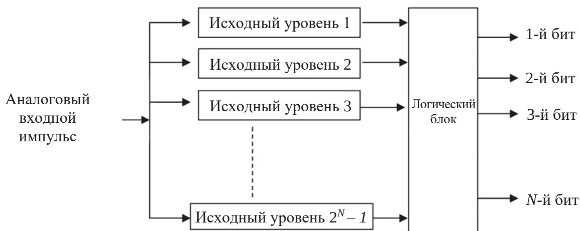
Рис. 7.12. Схема аналого-цифрового преобразователя FLASH, выдающего N бит цифровых данных
