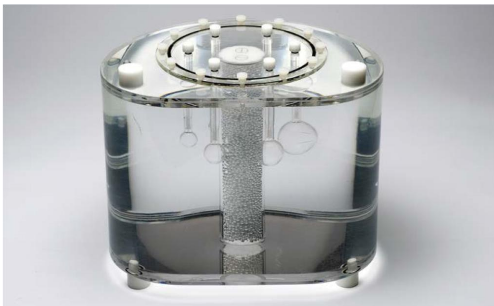
Рис. 15.18. Фантом качества изображения Национальной ассоциации производителей электрооборудования/Международной электротехнической комиссии
