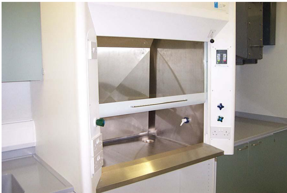
Рис. 9.7. Вытяжной шкаф, предназначенный для использования с радиоактивными материалами
