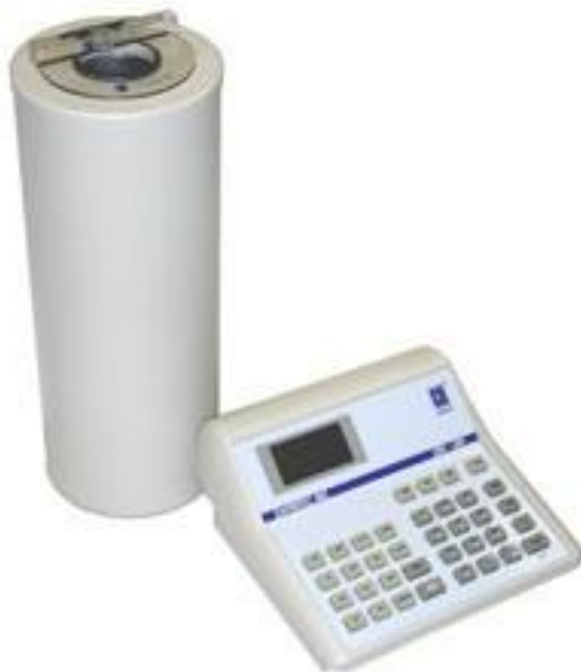
Рис. 9.1. Типичный калибратор дозы (например, CRC 25R)
