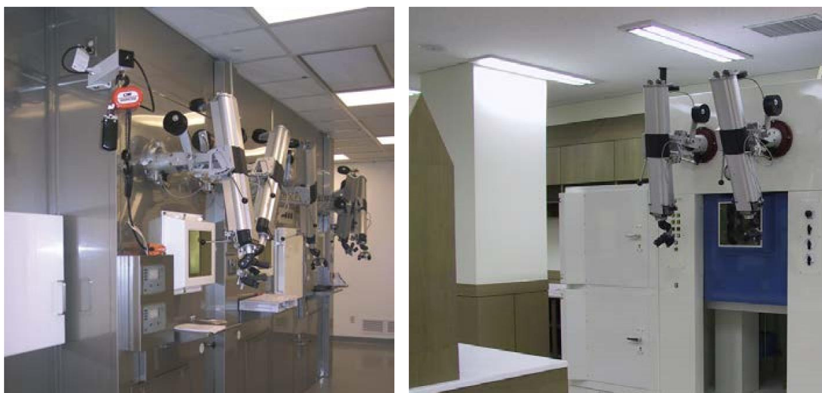
Рис. 4.17. Примеры современных конструкций хот-боксов (любезно предоставлено компанией Фон Гален Недерланд Б. В.)
