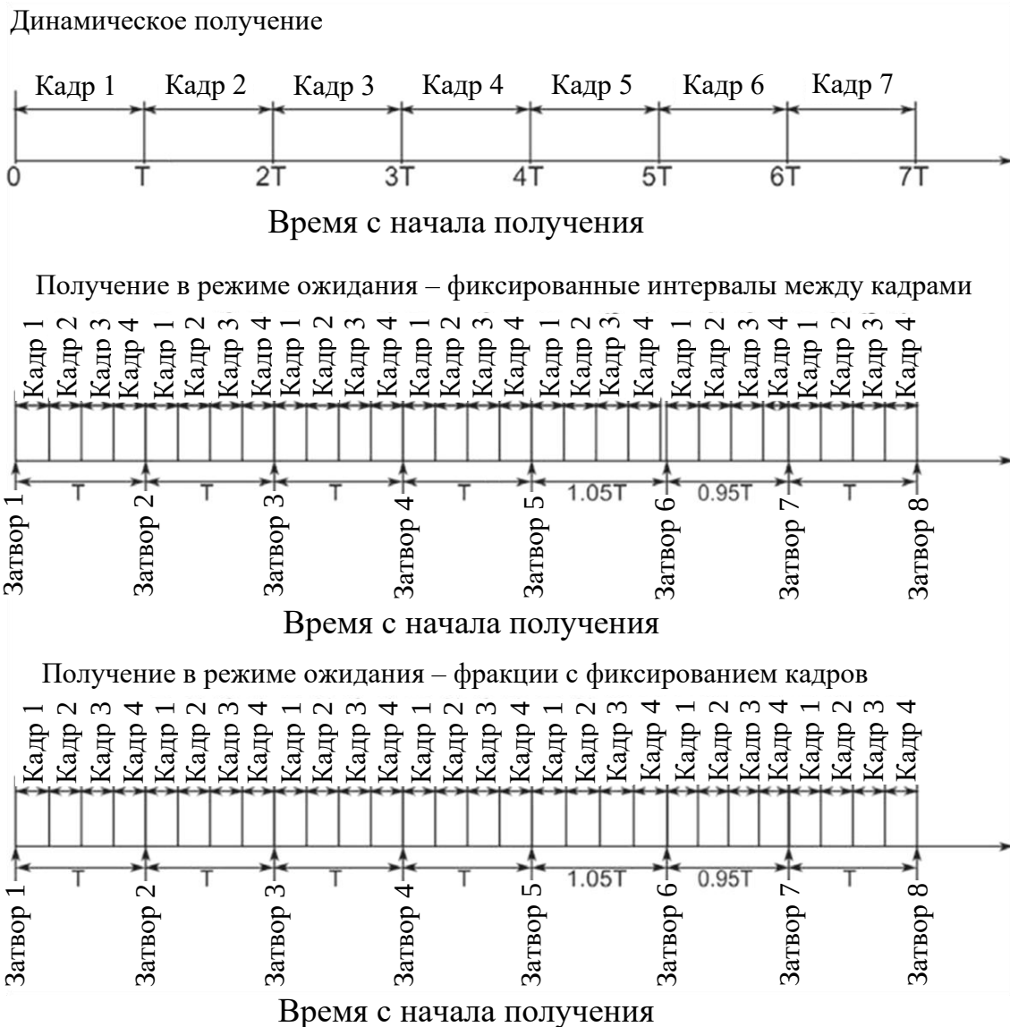
Рис. 11.20. Сравнение динамического и закрытого режимов съемки. Во всех случаях время отображается вдоль горизонтальной оси. При динамической съемке фотоны формируются в различные изображения в зависимости от времени после съемки. В этом случае интервал между динамическими кадрами равен T . При стробированном получении фотоны формируются в набор изображений на основе времени по отношению к предыдущему сигналу затвора. Сигнал затвора выводится из физиологического триггера, такого как R-волна в сигнале электрокардиограммы. Для двух примеров динамического стробирования интервал времени между сигналами затвора 1–5 и 7–8 одинаков, но интервал между сигналами затвора 5–6 и 6–7 на 5 % длиннее и на 5 % короче среднего интервала. Проиллюстрированы два метода разделения временного интервала между затворами, фиксированные интервалы и фиксированные доли. В методе с фиксированным интервалом фотоны помещаются в рамки с фиксированной шириной. В этом случае дополнительное время (5 % от T ) между элементами 5–6 не учитывается, а интервал, в течение которого подсчитываются фотоны в кадре 4 в интервале времени между элементами 6–7, сокращается на 20 % (5 % от T )
