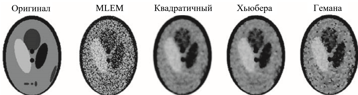
Рис. 13.17. Реконструкции фантома Шеппа-Логана по методу максимизации ожидания максимального правдоподобия (MLEM) и по методу максимального апостериорного правдоподобия. Использовались три различных сглаживающих априора: квадратичный, Хьюбера и Гемана. Последние сглаживают малые различия квадратично, но более терпимы к большим краям
