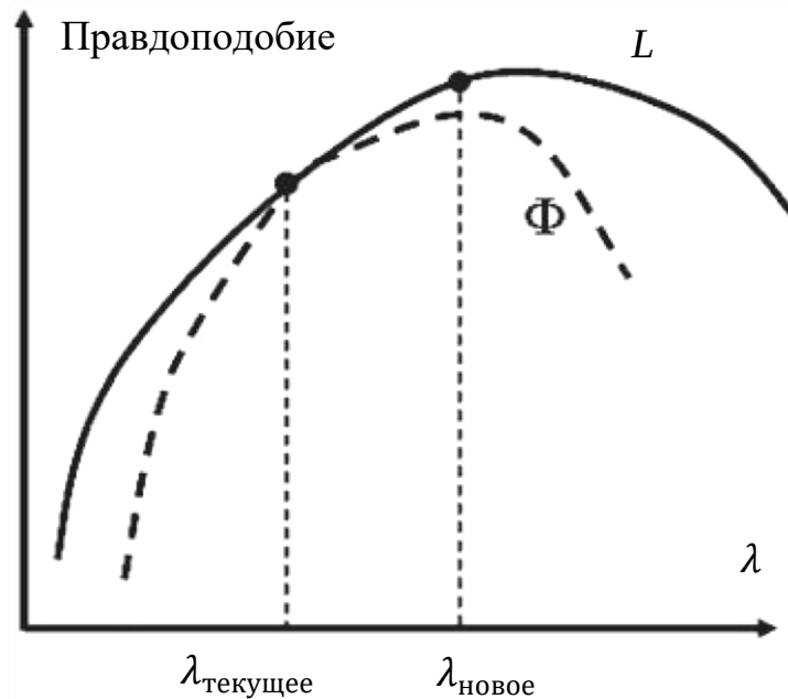
Рис. 13.12. Перенос оптимизации: разрабатывается суррогатная функция, которая равна правдоподобию в текущей реконструкции и меньше или равна везде
