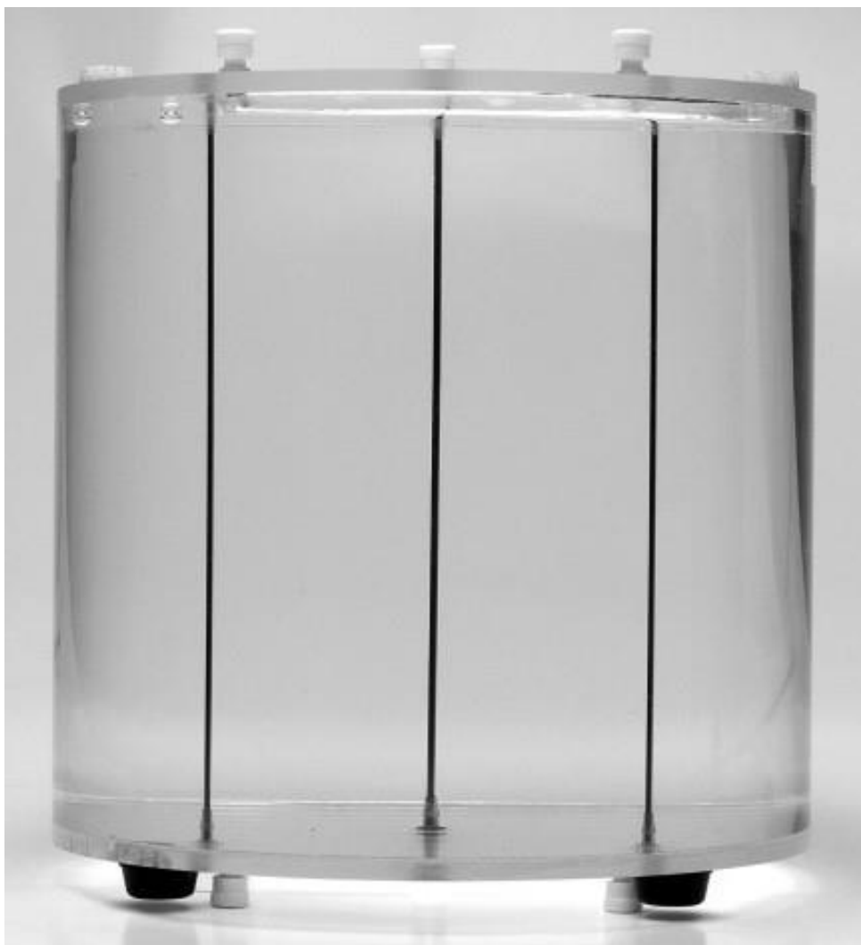
Рис. 15.10. Коммерческий фантом трехлинейного источника с тремя линейными источниками внутри. Резервуар заполнен водой для имитации рассеивающей среды
