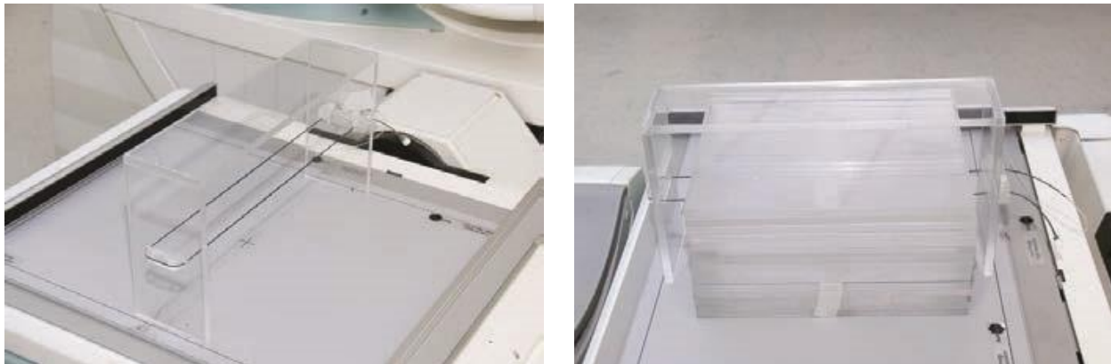
Рис. 15.4. Изготовленный на заказ фантом с двумя линейными источниками. Слева фантом расположен на детекторе, а справа те же линейные источники погружены в рассеивающую среду, состоящую из листов «Перспекс»
