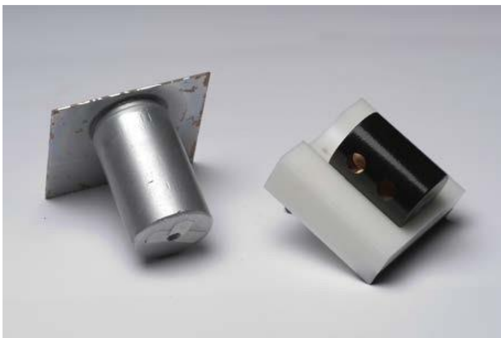
Рис. 15.1. Держатели точечных источников в наклонном положении, чтобы они могли указывать на детекторы с пола
