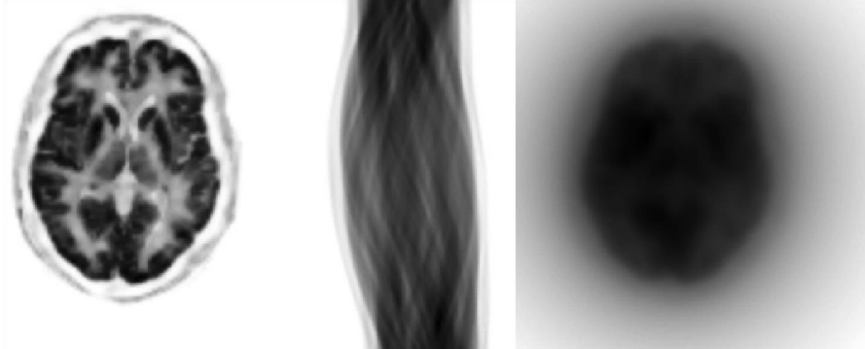
Рис. 13.2. Изображение (слева) проецируется для получения синогаммы (в центре), которая, в свою очередь, проецируется обратно, получая сглаженную версию исходного изображения
