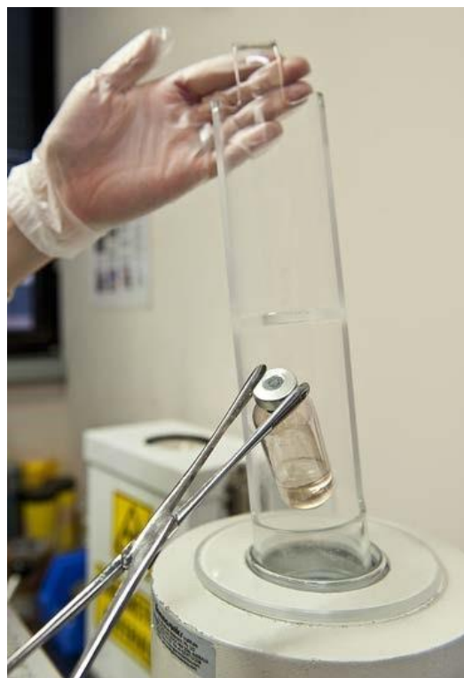
Рис. 9.11. Использование длинных щипцов для работы с пробиркой, содержащей радиоактивность
