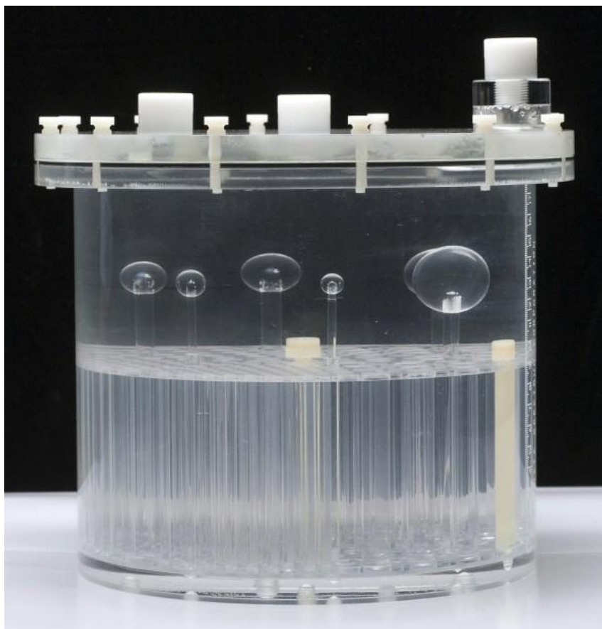
Рис. 15.12. Фантом Яцака, используемый для проверки качества изображения (фантом фирмы Data Spectrum Corporation, США)
