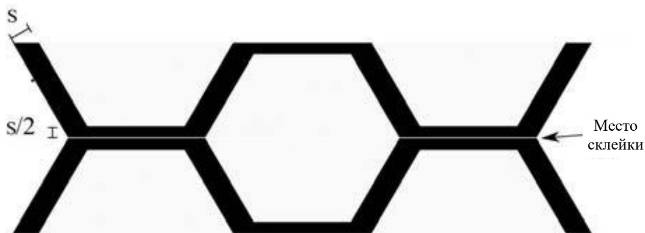
Рис. 11.5. Иллюстрация изготовления коллиматора из фольги путем склеивания двух свинцовых фольг с тиснением. Следует отметить, что фольга должна быть отштампована таким образом, чтобы склеиваемые участки перегородок были вдвое толще остальных перегородок. Кроме того, для сохранения формы отверстий необходимо тщательное выравнивание
