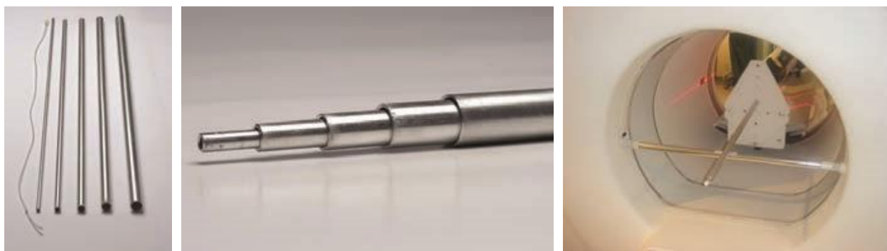
Рис. 15.20. Изображения фантома чувствительности Национальной ассоциации производителей электрооборудования: позиционирование фантома внутри портала (справа). Для подвешивания фантома в поле зрения используются натянутый пружиной карниз и держатель точечного источника. Алюминиевые втулки (слева и в центре) должны совпадать с центром осевого поля зрения
