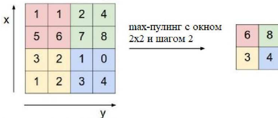
Рисунок 9 – Принцип работы max-пулинга
