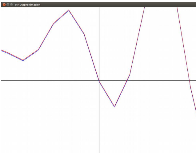
Рис. 19.1 модель сети ПНС. 3+2 нейронов в двух скрытых слоях
