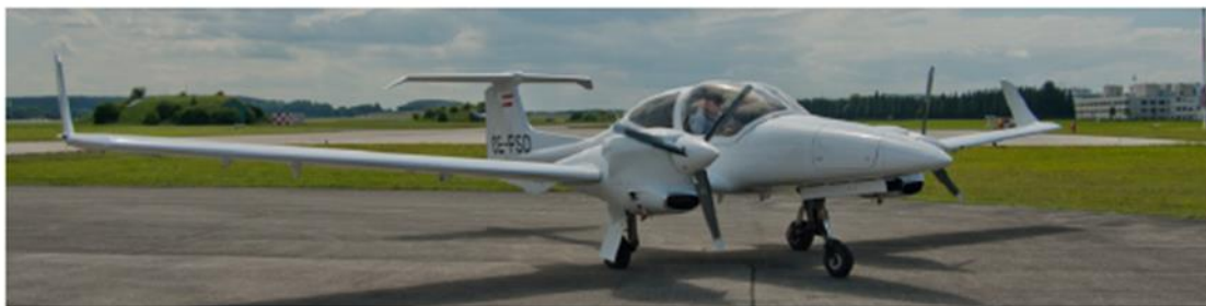
Рис.1: Экспериментальный ЛА (DA-42MPP NG) со встроенной электродистанционной системой управления полётом
